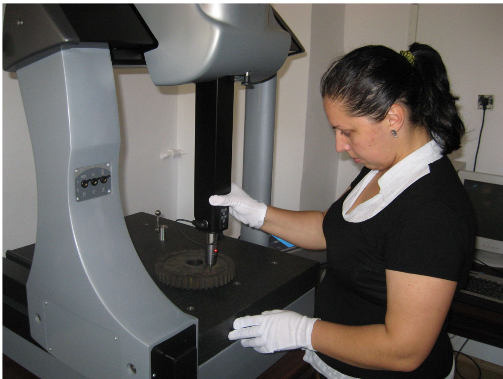
Figura 6. 6. Măsurarea profilului roții pe mașina Micro Hite 3D (la Universitatea Dunărea de Jos echipament procurat prin contractul de cercetare ID_656/2007)
